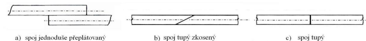
Obr. 23 Spoj tupý a spoj tupý zkosený
