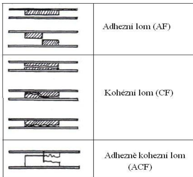
Obr. 2 Základní typy porušení lepeného spoje
