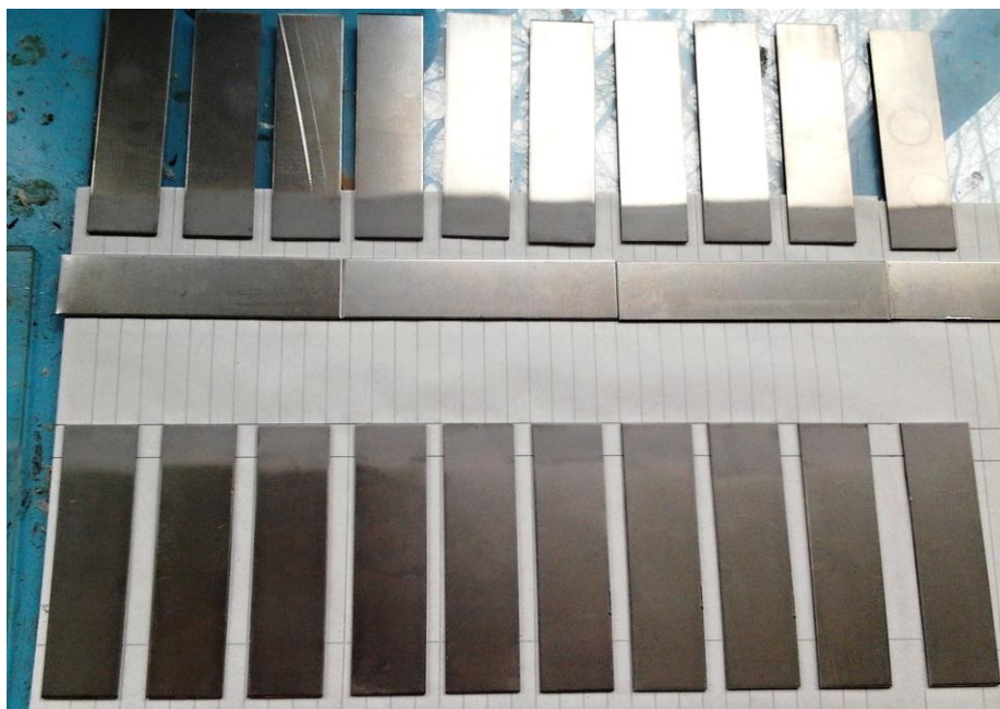
Obr. 10 Rozmístění zkušebních tělísek před lepením
