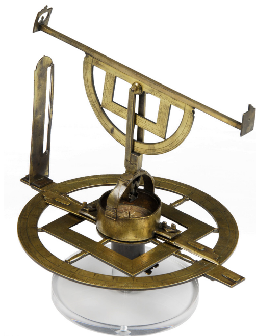
Obr. 1.4: Prístroj na meranie uhlov nazvaný Instrument Topographicall
