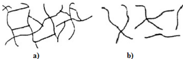
Obr. 2.6 Polymerní řetězce, a) termoset, b) termoplast, [12]
