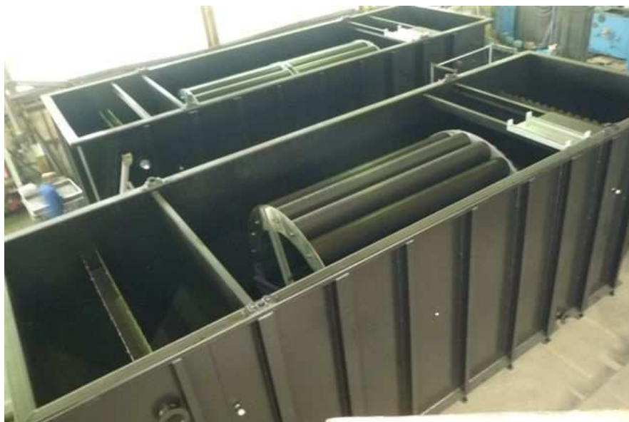
Obrázek 2.6 Kontejnerová čistírna pro 250-500 EO [11]
