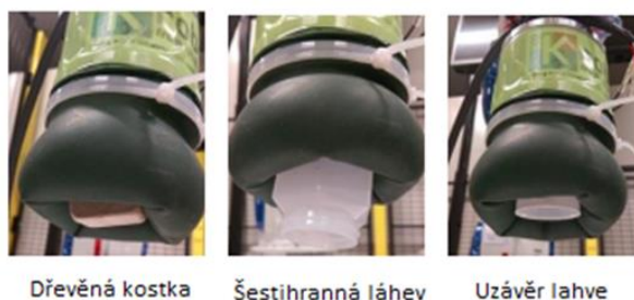
Obr. 21) Uchopování předmětů různých tvarů[17]
