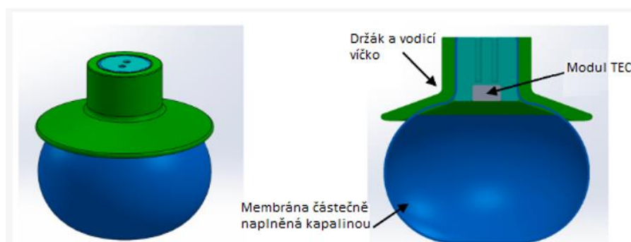
Obr. 19) Chapadlo s efektem Jamming (zmrazení)[20]
