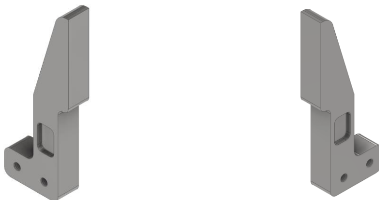
Obr. 26) a) Předběžný náhled levého prstu pro průstřižnice a nůž, b) Předběžný náhled pravého prstu pro průstřižnice a nůž
