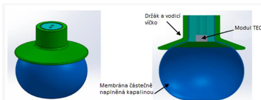
Obr. 19) Chapadlo s efektem Jamming (zmrazení)[20]
