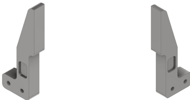
Obr. 26) a) Předběžný náhled levého prstu pro průstřížnice a nůž, b) Předběžný náhled pravého prstu pro průstřížnice a nůž
