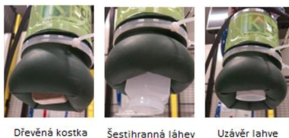
Obr. 21) Uchopování předmětů různých tvarů[17]
