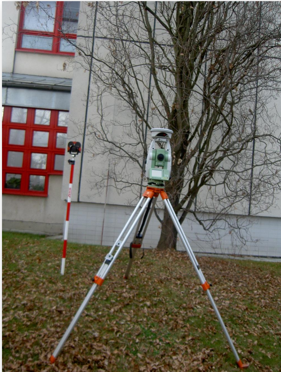
Obrázek 8: Totální stanice Leica TCRM1205 R300 s přenosnou GS09 Basie, GNSS dvoufrekvenční SmartAnténou
