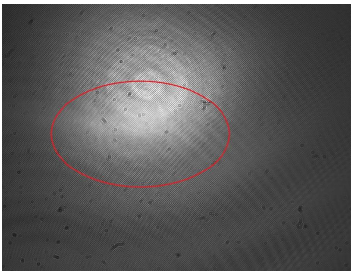
Obrázek 25 - Plyn unikající ze zapalovače-snímek z videa obsahující plyn (oblast uvnitř červené elipsy)
