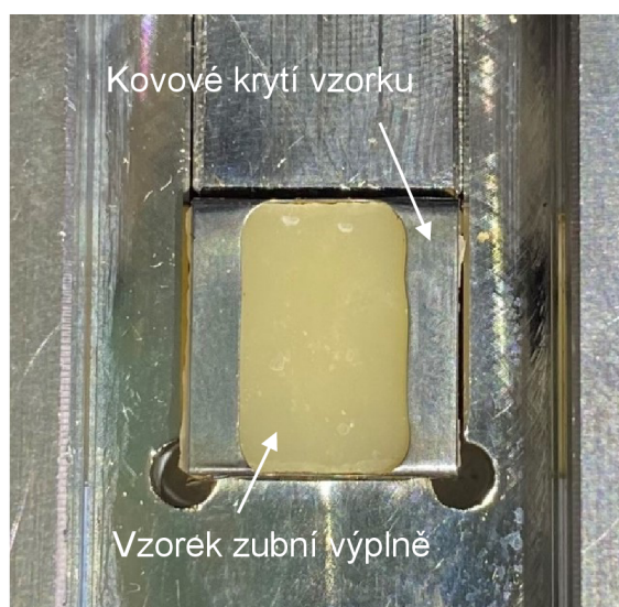
obr. 4-10 Detail krytí vzorku
