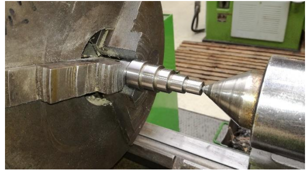
Obr. 25 Upínání dlouhého obrobku a jeho podepření otočným hrotem.
