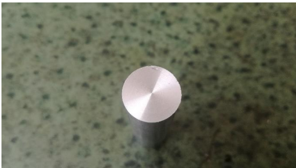
Obr. 20 Povrch hliníkového válečku po obrábění se správně vyoseným soustružnickým nožem.
