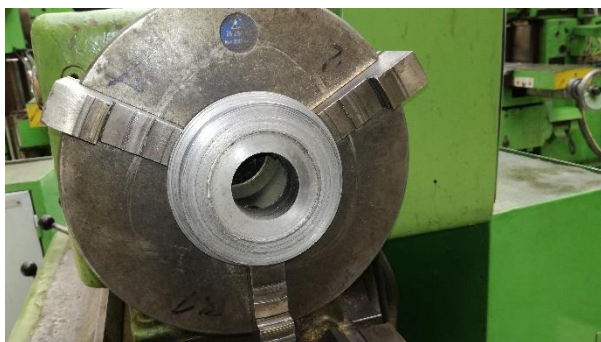
Obr. 22 Upínání obrobku do obrácených čelistí.
