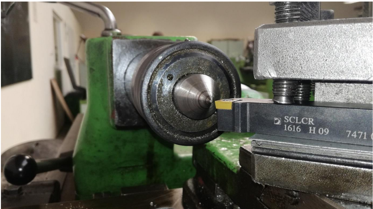
Obr. 17 Nastavení výšky soustružnického nože na osu otočného hrotu.
