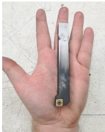
Obr. 13 Levý nůž směřující břitkem k levému palci.
