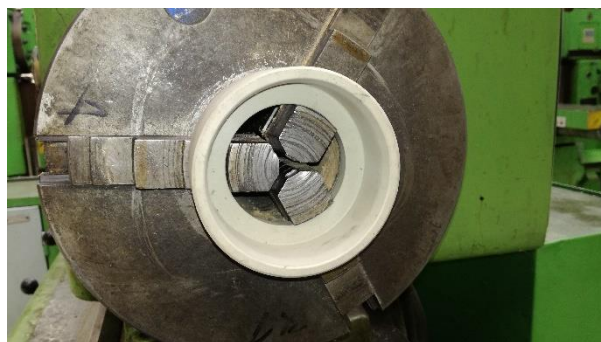
Obr. 23 Upínání obrobku za otvor.
