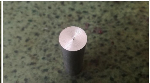
Obr. 21 Povrch hliníkového válečku po obrábění s nesprávně vyoseným soustružnickým nožem.
