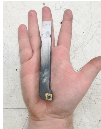
Obr. 14 Pravý nůž směřující břitkem k pravému palci.
