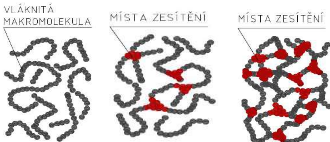
Obr. 8a Vlákenná makromolekula [12] Obr. 8b Zesíťování reaktoplastů [12] Obr. 8c Zesíťování elastomerů [12]
