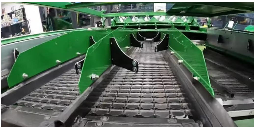
Obrázek 48: Příčky s kurtami pro rovnoměrné rozvrstvení materiálu na svahu
