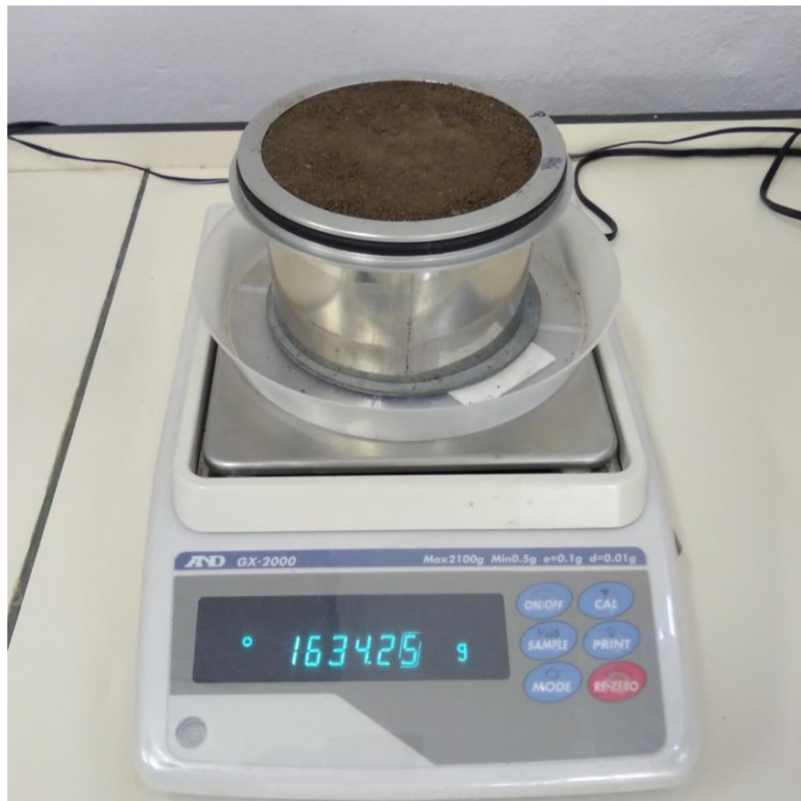
Obrázek 10 - Půdní vorek v ocelovém límci (vlastní měření)
