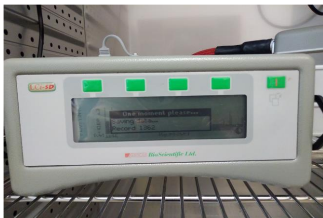
Obrázek 7 - Hlavní konzole s velkým displejem z tekutých krystalků (LCD), s pěti tlačítkovou klávesnicí (vlastní fotodokumentace)
