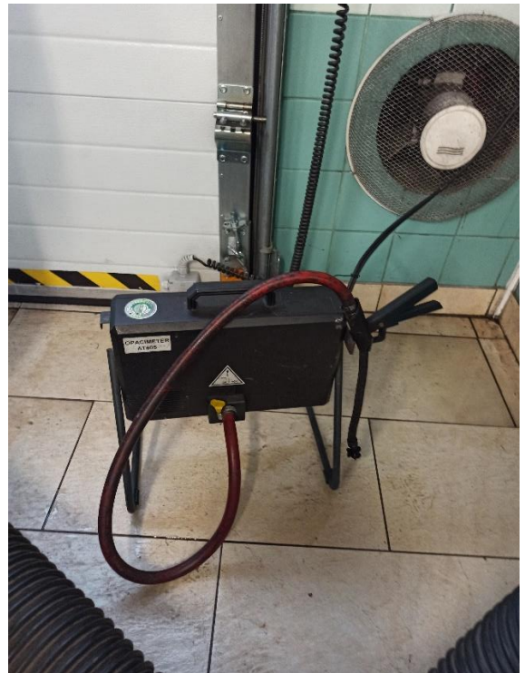
Obr. č. 24 Opacimetr – měří kouřivost (nafta).
