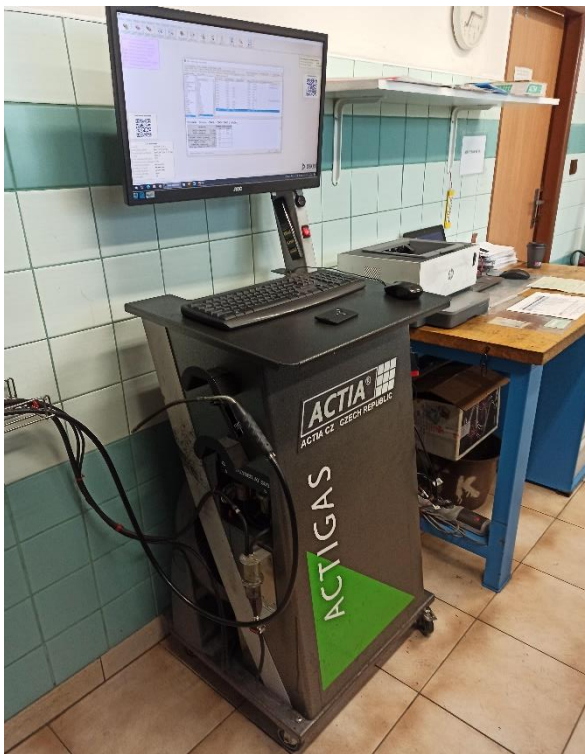
Obr. č. 23 Analyzátor výfukových plynů.
