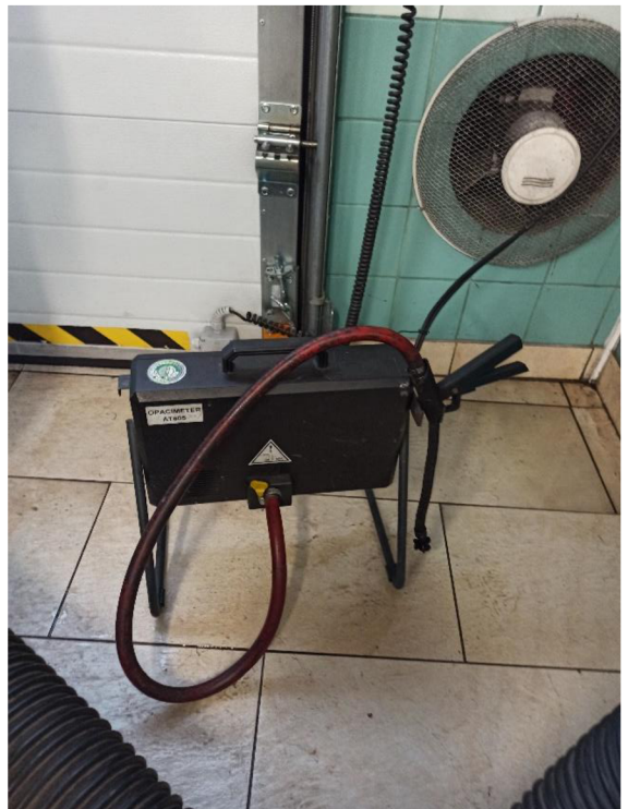
Obr. č. 24 Opacimetr – měří kouřivost (nafta).
