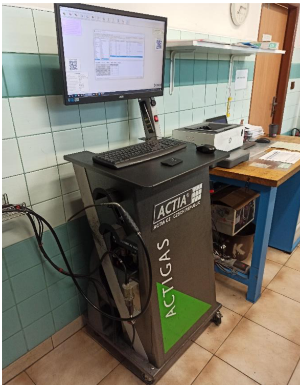
Obr. č. 23 Analyzátor výfukových plynů.
