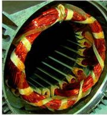
Obrázok 5 Príklad rozloženého vinutia [5]
