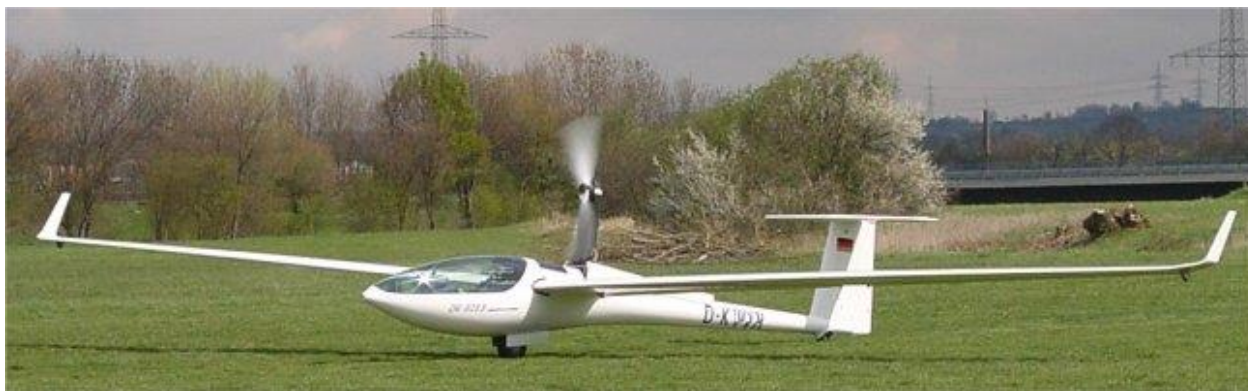
Obrázok 12 Príklad pohonu umiestneného na pylóne
