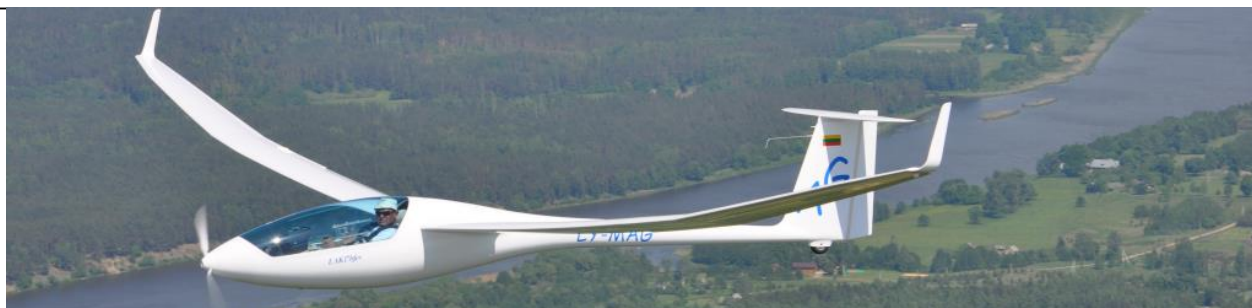
Obrázok 13 Príklad pohonu s prednou montážou
