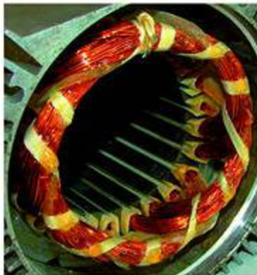
Obrázok 5 Príklad rozloženého vinutia [5]
