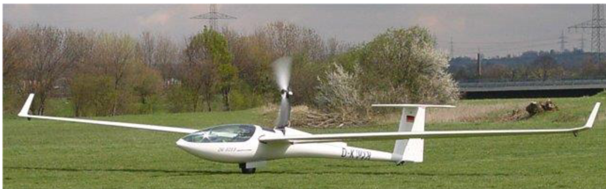
Obrázok 12 Príklad pohonu umiestneného na pylóne
