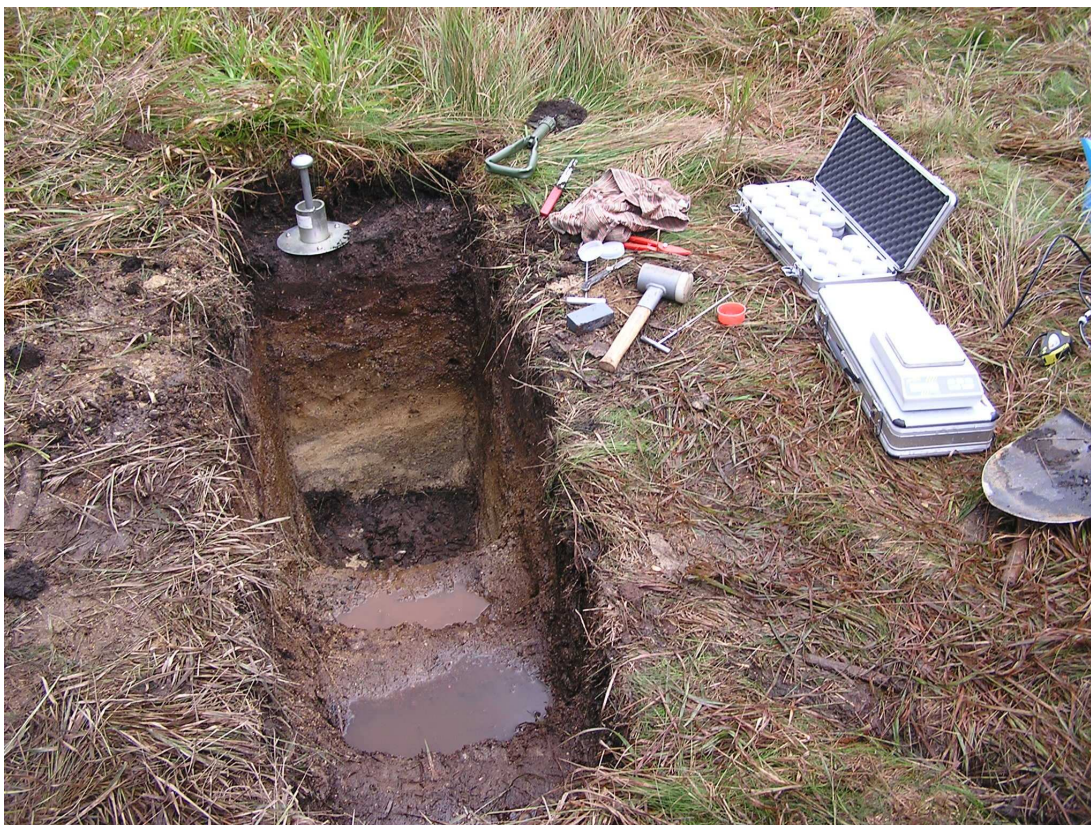
Obrázek 13 Odběr vzorků do Kopeckého válečků
