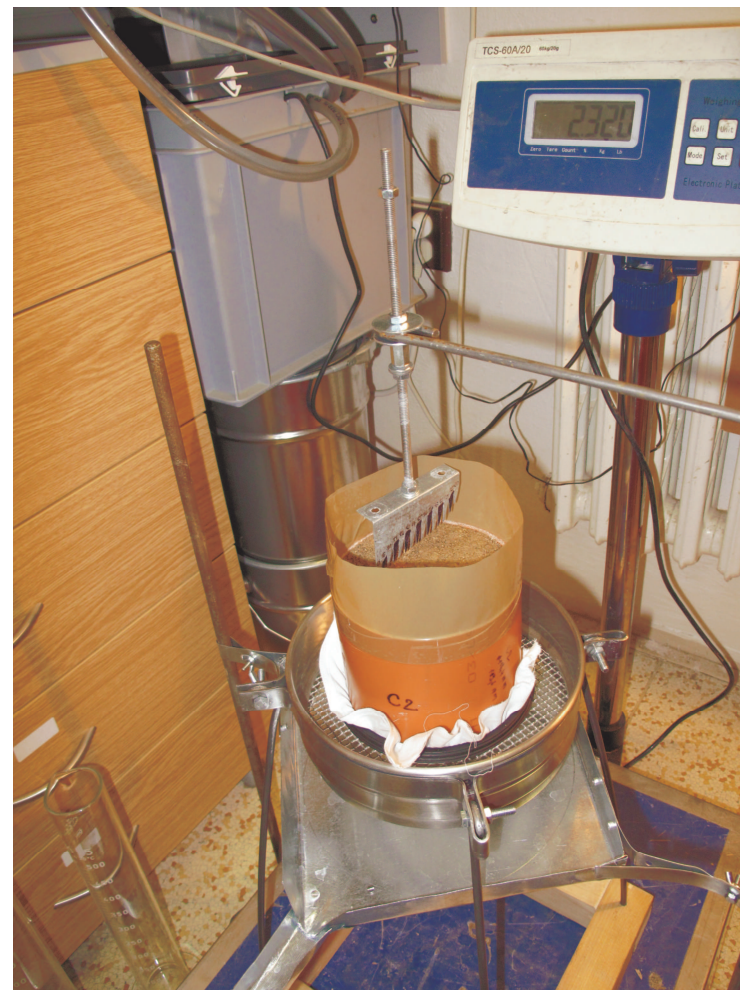
Obrázek 24 Měřící aparatura pro infiltračně výtokový experiment
