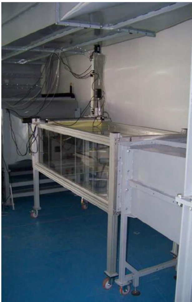
Obrázek 6-3 Reálná měřicí sekce (vlevo) Traverzér s měřicí sondou (vpravo) [16]
