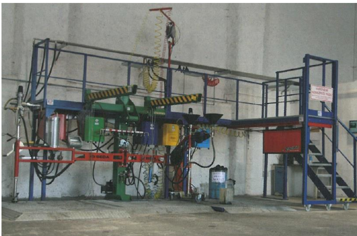
Obrázek 10: Odsávací linka na odčerpání provozních kapalin z autovraku (CZ EKO s.r.o.)
