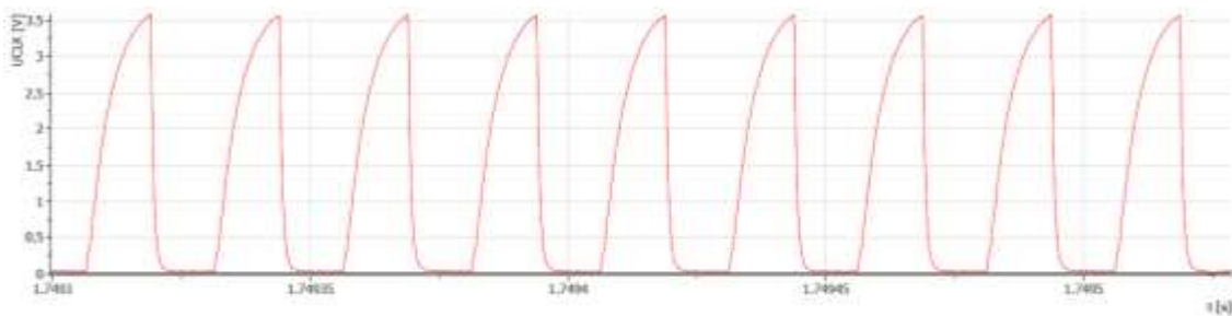
Obrázek 44. Průběh hodinového signálu SCL při frekvenci f = 100 kHz na straně 15 V pro n = 2 extendery
