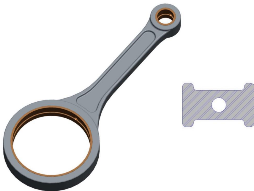
Obr. 21 Ojnice se zalisovanými pouzdry a s řezem dřívku
