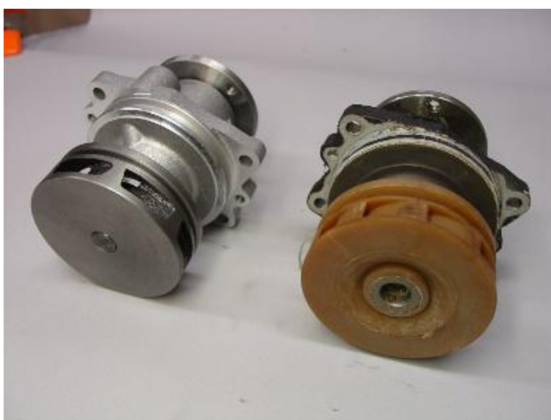
Obr. 1 Porovnání vodní pumpy z plastu a železa v osobním autě [1]
