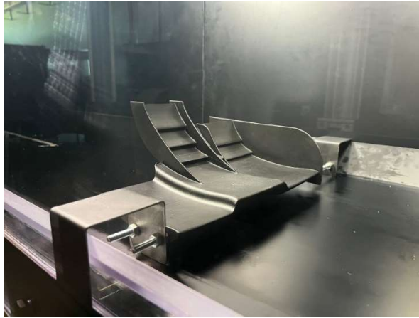
Obr. 75 Model zmenšenej polovice predného krídla vo veternom tunely [50]
