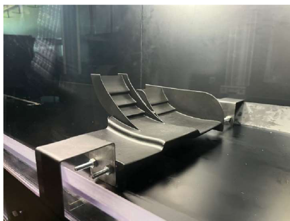
Obr. 75 Model zmenšenej polovice predného krídla vo veternom tunely [50]
