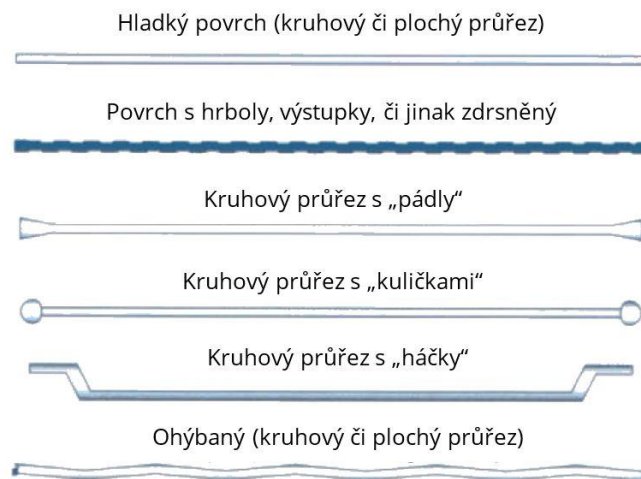
Obr. 5 Typy ocelových vláken používaných v betonu [21]
