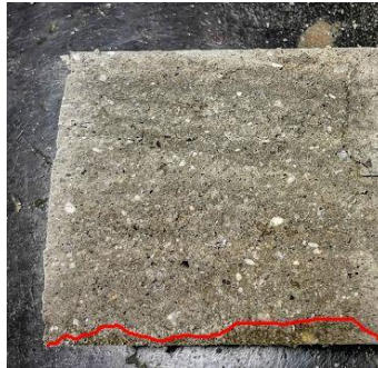
Obr. 60 Vzorek vývrtu z referenční hmoty po zkoušce stanovení hloubky průsaku tlakovou vodou
