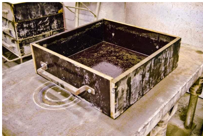
Obr. 12 Bedna pro zkoušení stříkaného betonu
