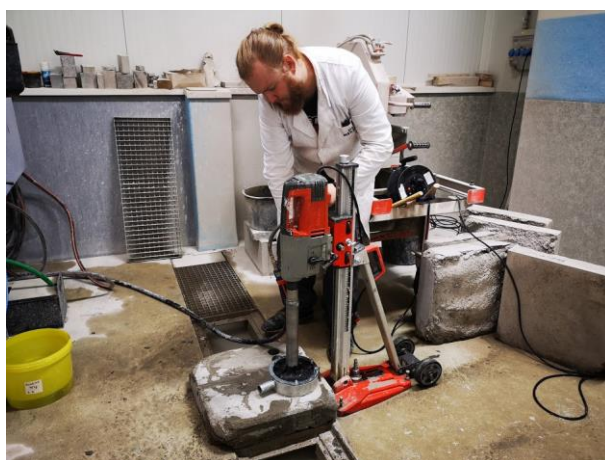
Obr. 15 Provádění jádrových vývrtů
