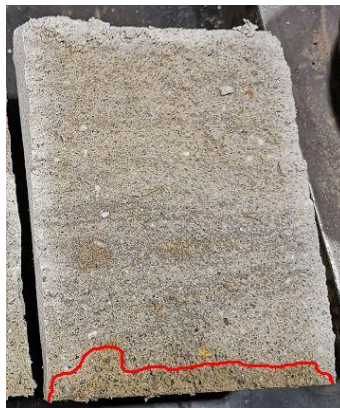
Obr. 61 Vzorek vývrtu z hmoty obsahující slévárenský písek a jemně mleté obalové sklo po zkoušce stanovení hloubky průsaku tlakovou vodou
