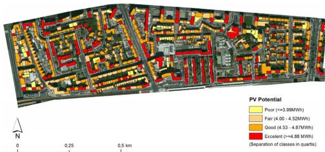
Obr. 12 Střešní plochy rozdělené podle množství potenciálně produkované elektřiny v části Lisabonu (Santos et al. 2014)
