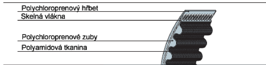
Obr. 49 Ozubené řemeny neoprenové HDT 5M [31]
