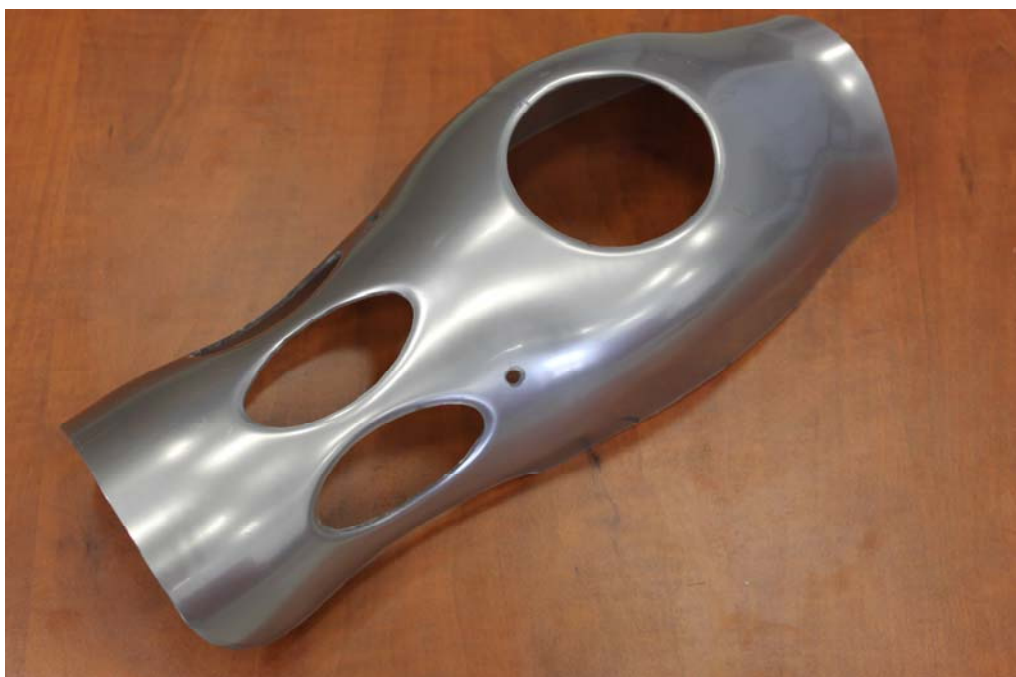
Hotový vyřezaný a obroušený přední kryt
