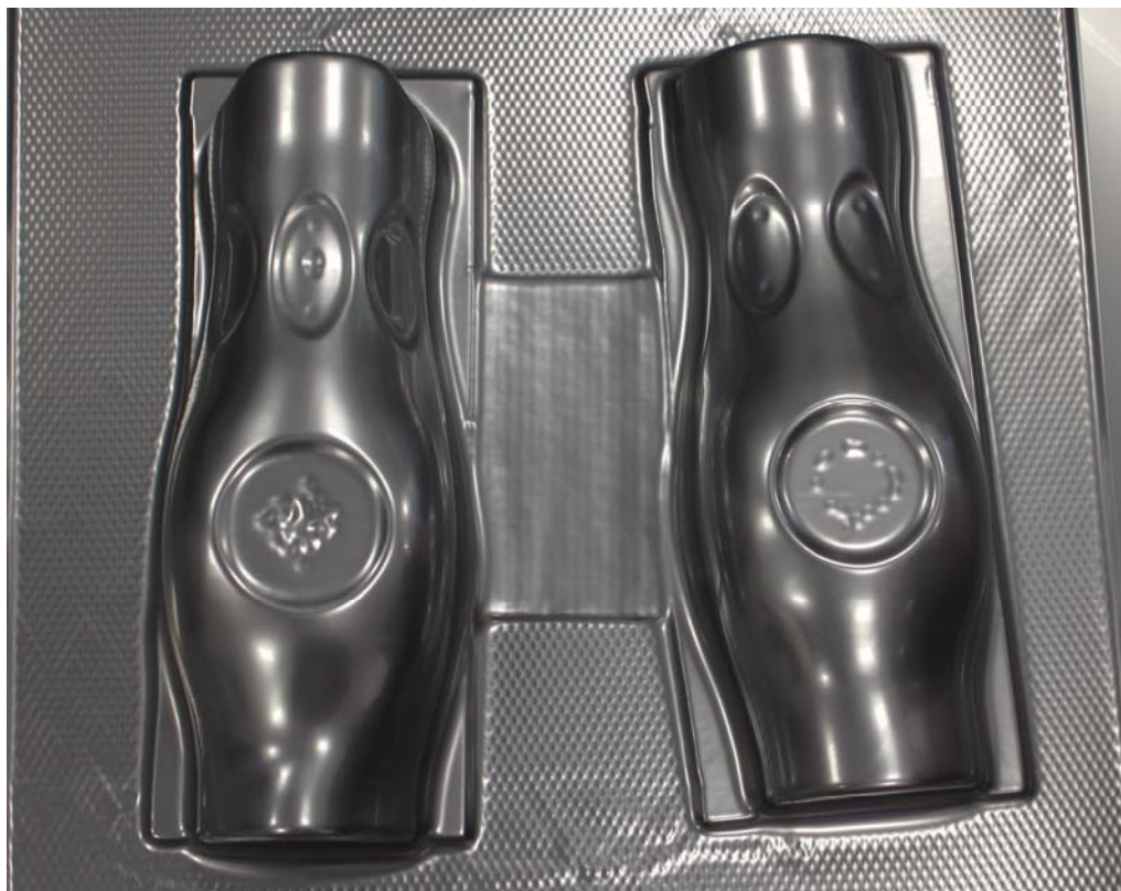
Odlisované kryty z kouřového plexi o tloušťce 3 mm
