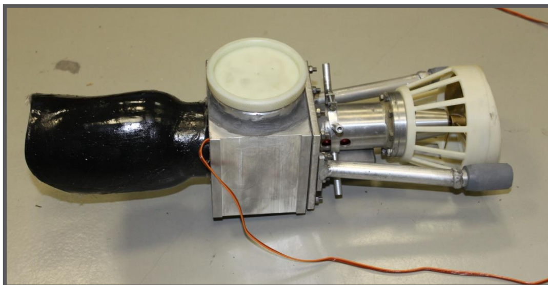
Obr. 4-32 Protéza s přišroubovaným lůžkem a silonovým víčkem
