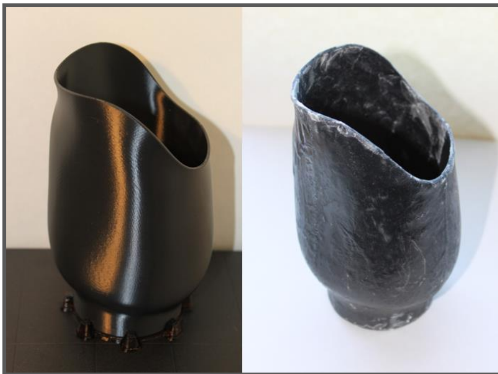
Obr. 4-31 Lůžko po vytisknutí a v průběhu laminování
