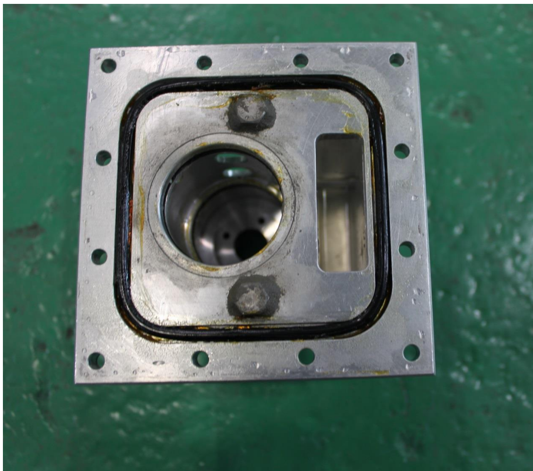
Patrný průnik vody do komory regulátoru
