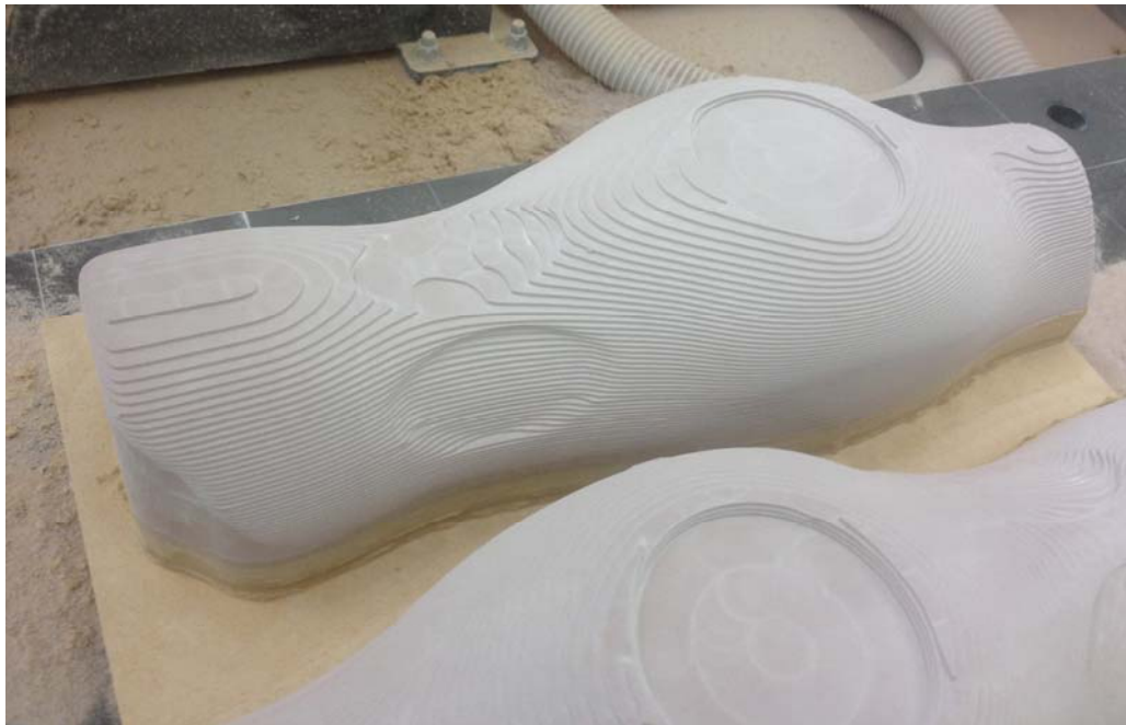
První krok při výrobě kopyt – hrubování frézovacím robotem
