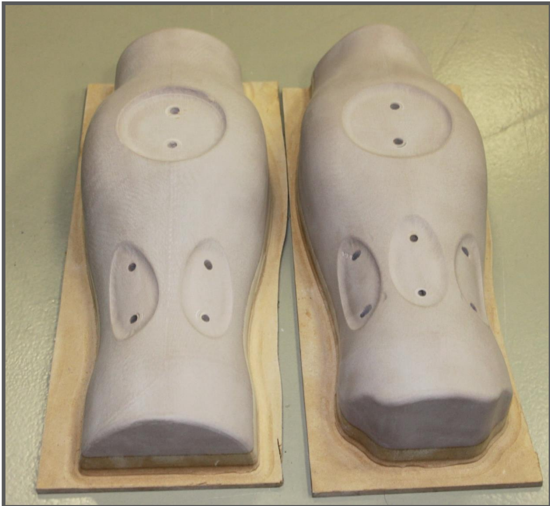
Obr. 4-33 Ofrézovaná a obroušená kopyta
