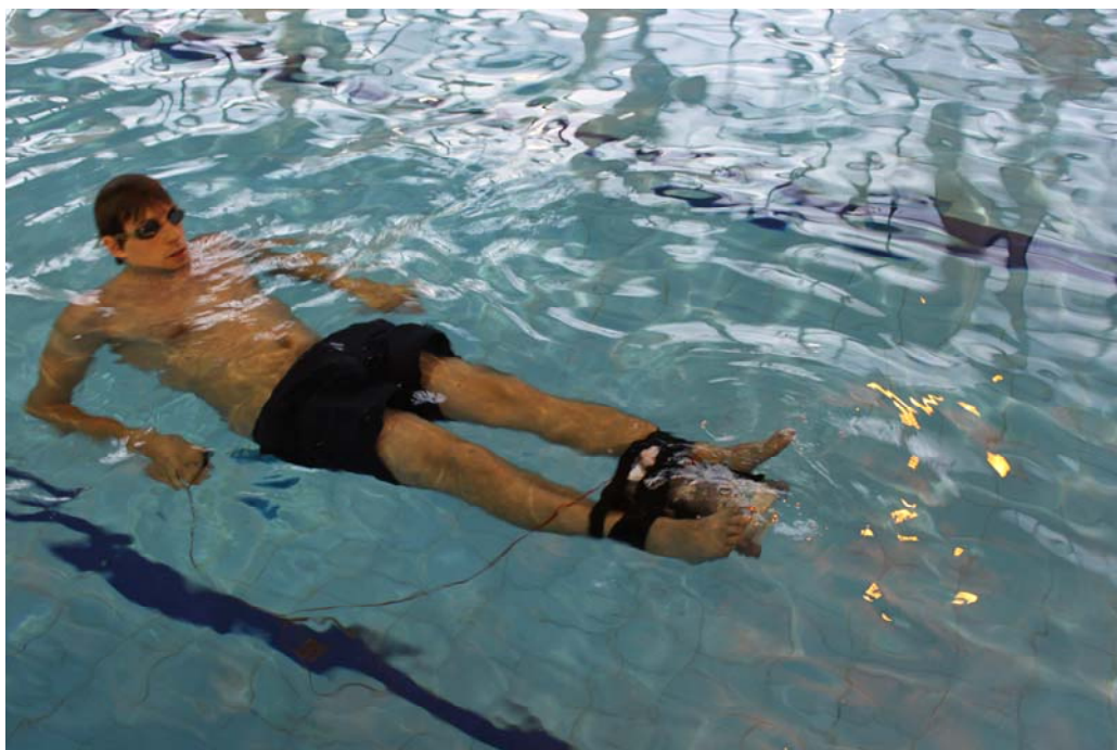
Zkouška vztlaku a rozběh lodního šroubu
