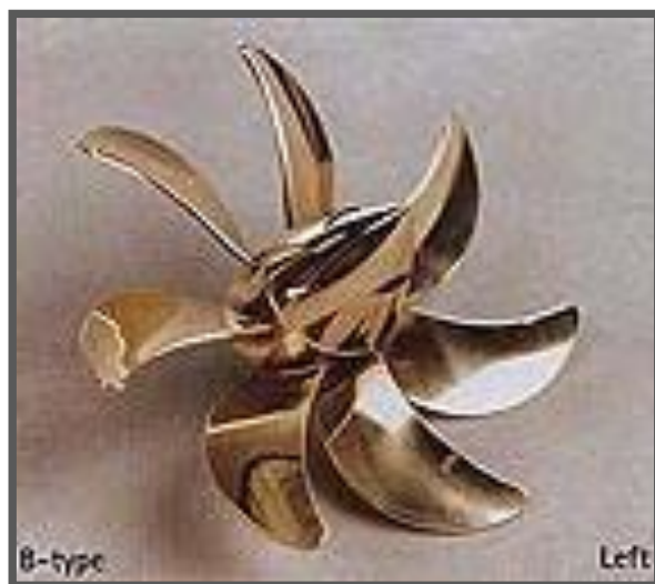
Obr. 1-13 Sedmilístý mosazný lodní šroub [17]
