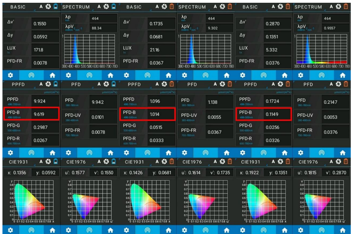
Obr. 14 Snímky obrazovky spektrofotometru při nastavení podmínek různé intenzity modrého světla. Hodnoty intenzity světla modrého spektra jsou zvýrazněny a uvedeny v jednotkách \mu\text{mol}\cdot\text{m}^{-2}\cdot\text{s}^{-1} .
