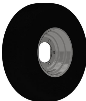
Obr. 26 Sestava disku kola a pneumatiky
