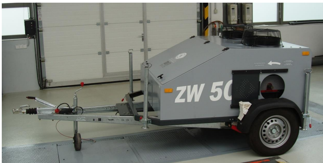
Obrázek 1.5: Mobilní dynamometr (Katedry.czu.cz, 2023)
