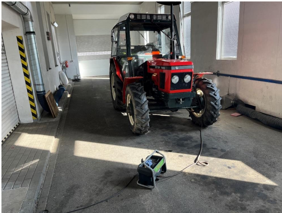
Obrázek 4.4: Příprava traktoru na měření kouřivosti
