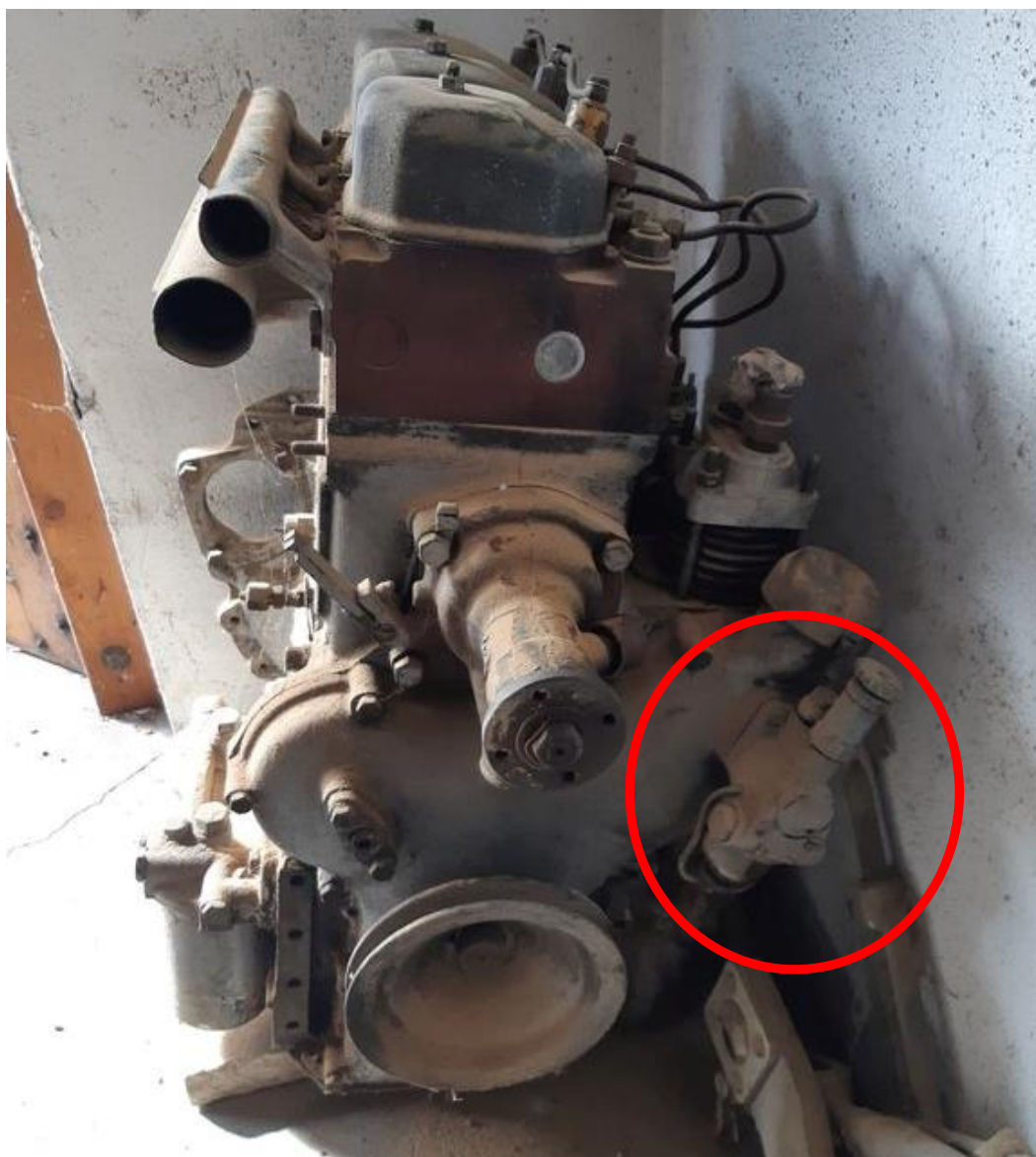
Obrázek 1.2: Umístění podávacího čerpadla (Sbazar.cz, 2023)
