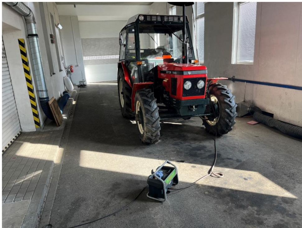
Obrázek 4.4: Příprava traktoru na měření kouřivosti
