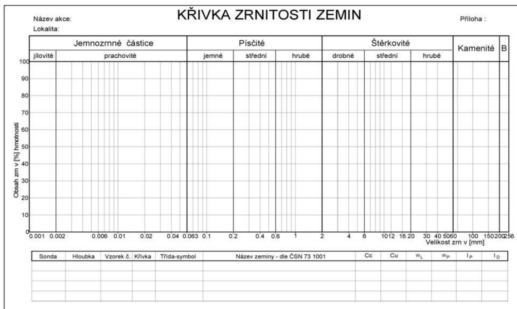
Obrázek 8: Arch pro vykreslení křivky zrnitosti zeminy [2]
