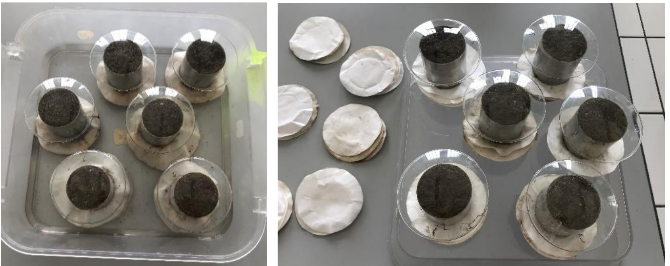
Obrázek 3: Fotografie při sycení a odsávání vzorků
