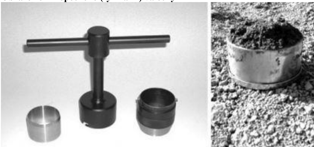
Obrázek 3 - Kopeckého (fyzikální) válečky
