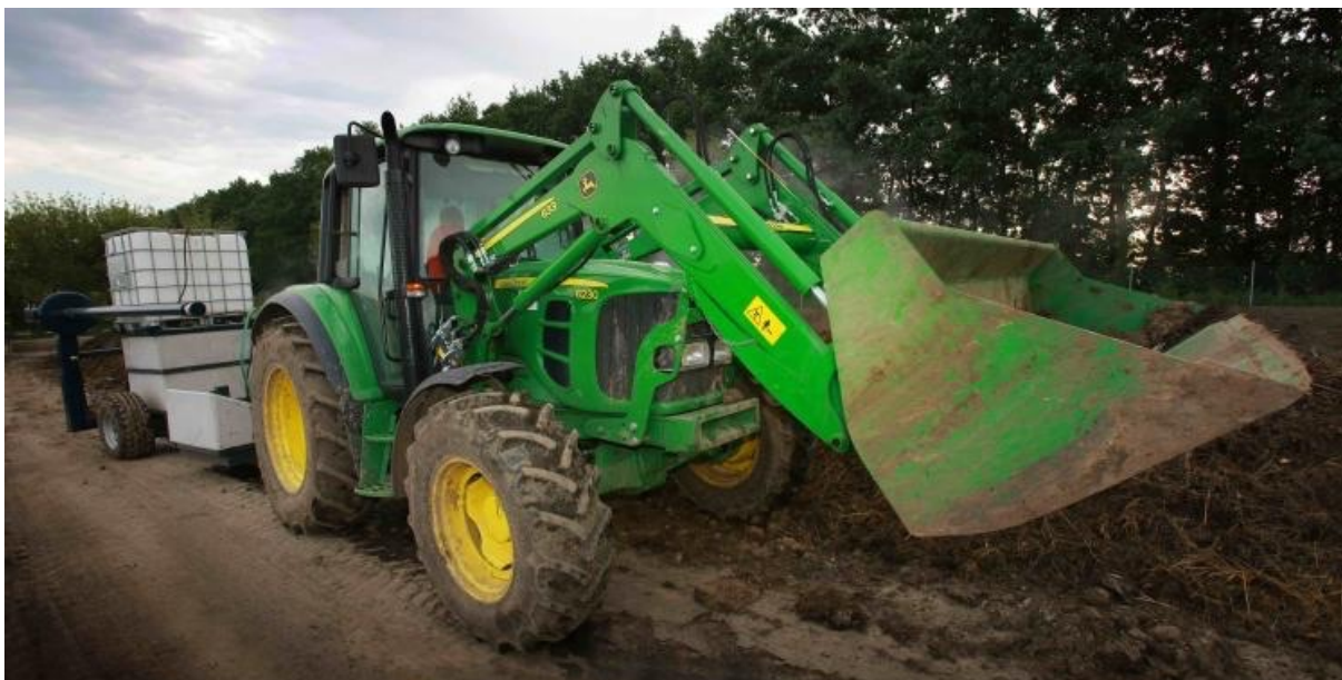
Obr. 3: Kolový traktor John Deere 6230 s čelním nakladačem a překopávačem CMC ST 300 s adaptérem při zvlhčování (zdroj: (37))
