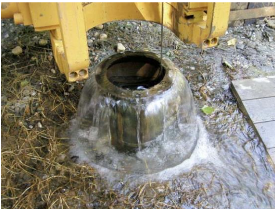
Obr. č. 4) Hydrogeologický vrt s kladnou úrovní piezometrické hladiny, která způsobuje přirozený přeliv (MŽP, 2010)
