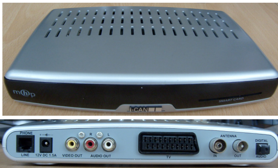
Obr. 5.5: Pohled na set top box iCAN (přední panel nahoře, zadní panel dole)
