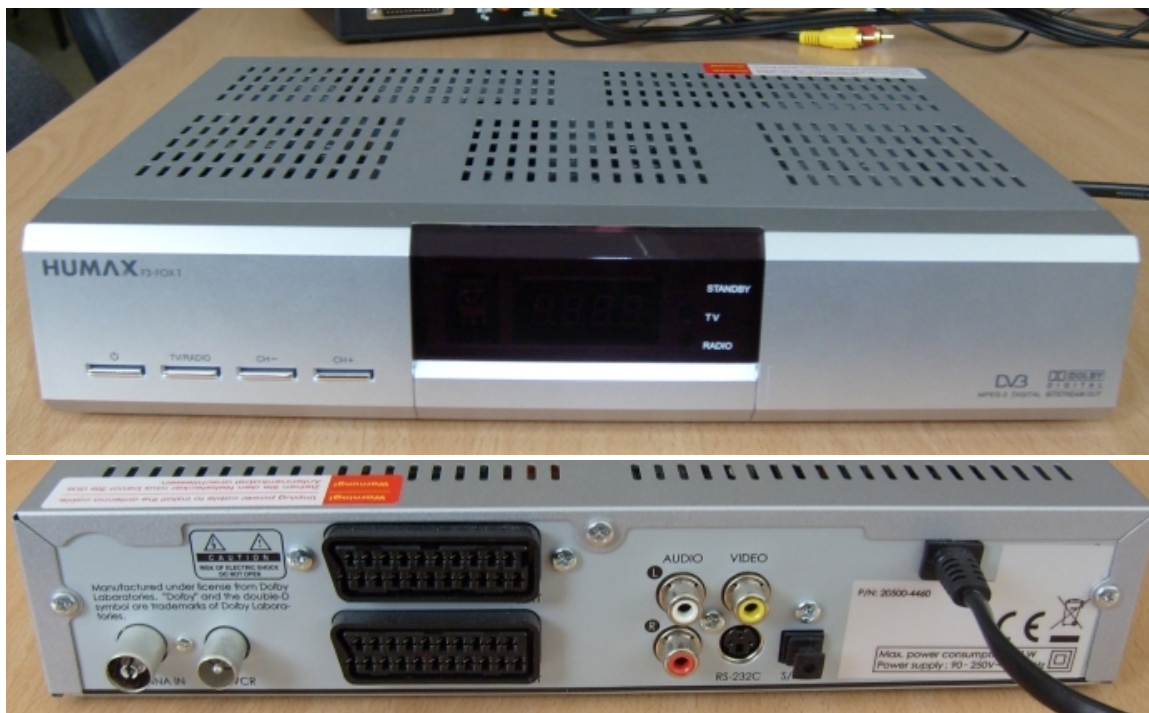
Obr. 5.1: Pohled na set top box HUMAX F3-FOX T (čelní panel nahoře, zadní panel dole)
