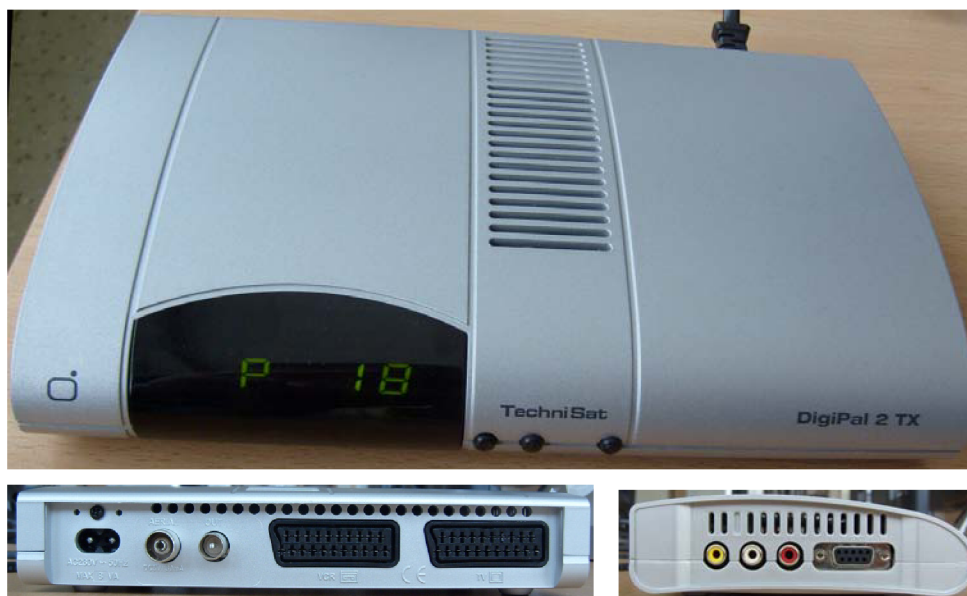
Obr. 5.3: Pohled na set top box TechniSat DigiPal 2 TX (čelní, zadní a boční pohled)
