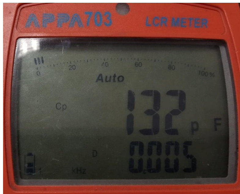
Obr. 4-16 Měření kapacity galvanického oddělení
