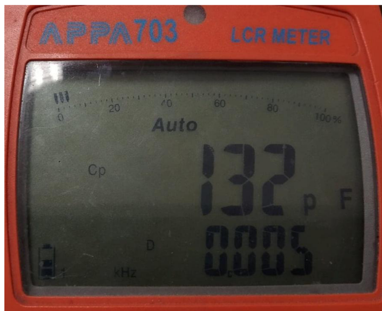
Obr. 4-16 Měření kapacity galvanického oddělení
