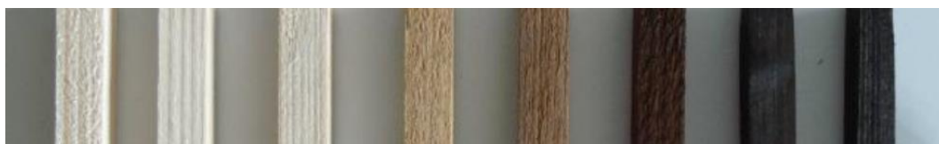
20 °C 100 °C 150 °C 200 °C 220 °C 240 °C 260 °C 280 °C Obrázek 2 : Postupně zvyšující se vliv teploty na barvu dřeva, jedle (Kučerová a kol., 2016)
