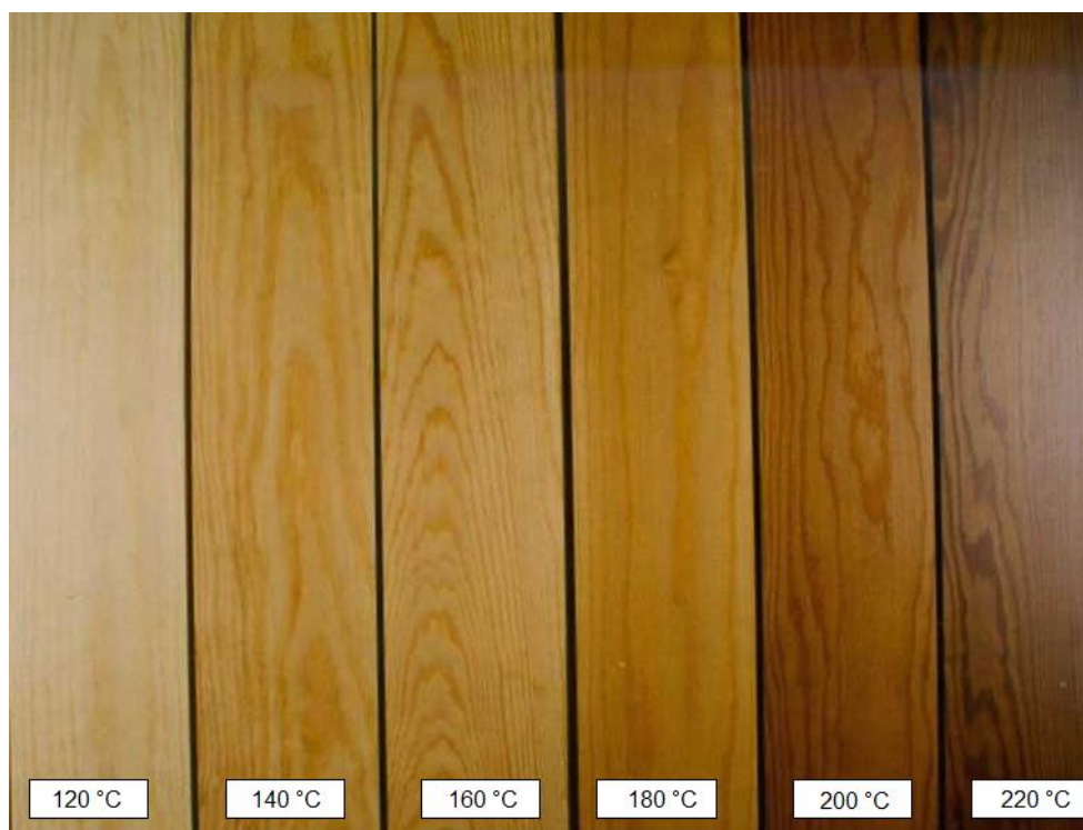
Obrázek 3: Změny barvy dřeva procesem ThermoWood ® , borovice (International Thermowood Association, 2003)
