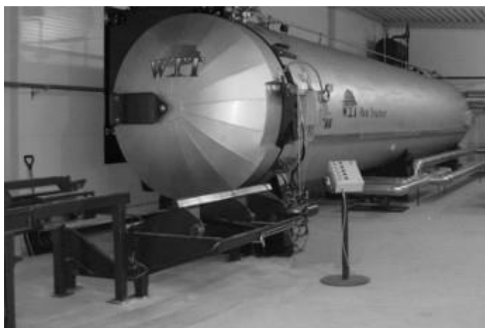
Obrázek 18: Autokláv společnosti WTT (WTT Service ApS, 2021)
