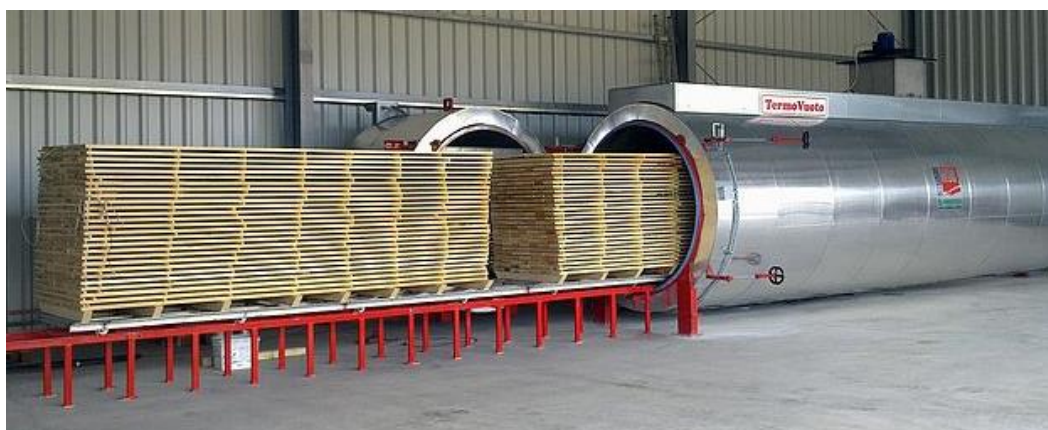
Obrázek 16: Termo-vakuová komora (WDE Maspell SRL, 2020)
