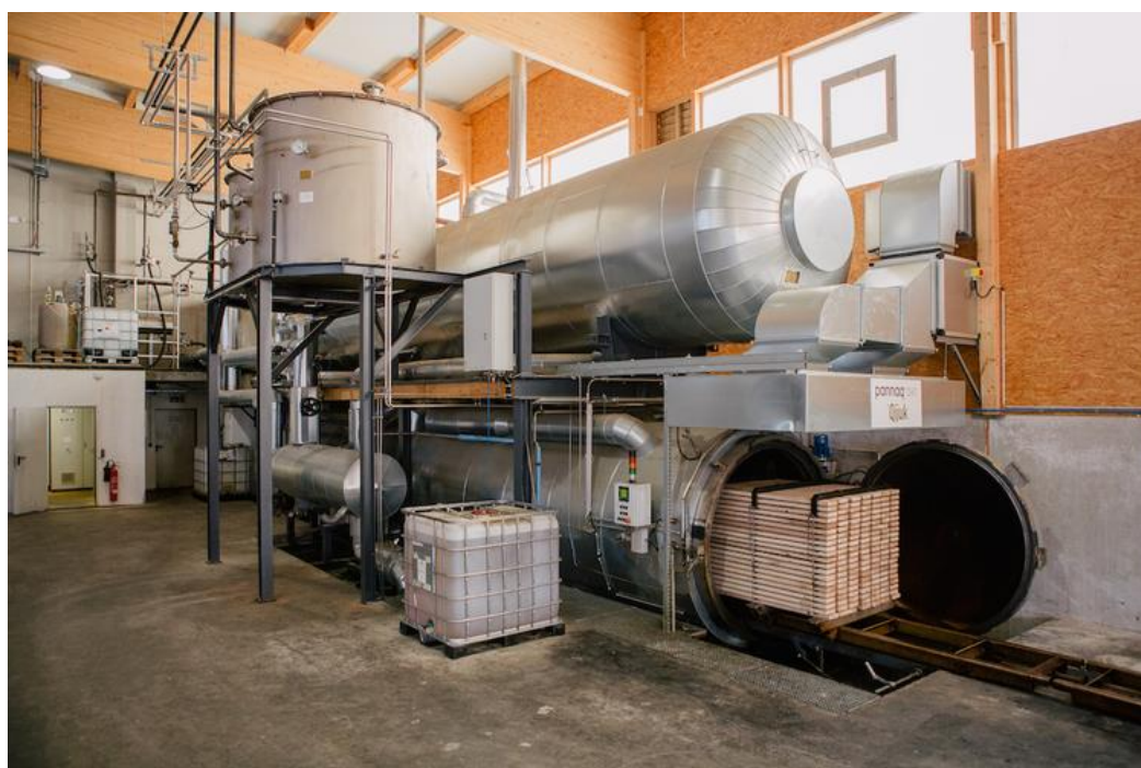
Obrázek 9: Autokláv společnosti Qijuk pro proces OHT (Qijuk Design Innovations Inc., 2020)
