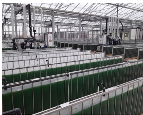
Obr. 3.22: Ploché panely ve skleníku (femonline.it, 2021)
