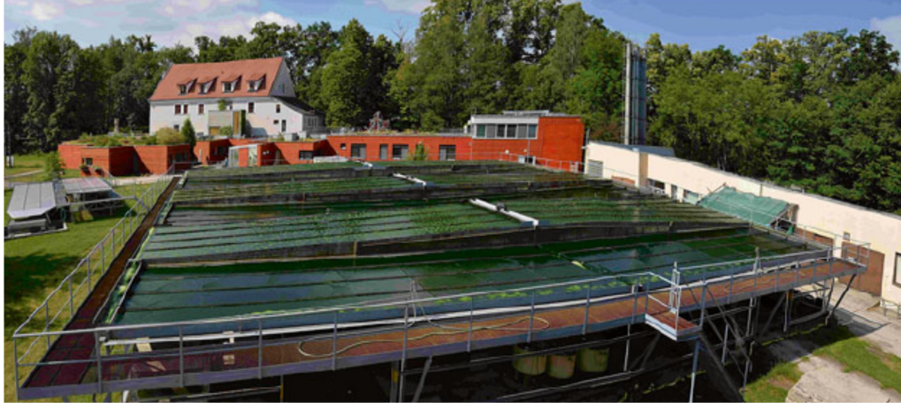
Obr. 3.20: Otevřená kultivační kaskáda v centru ALGATECH Třeboň (Masojídek et al., 2015)
