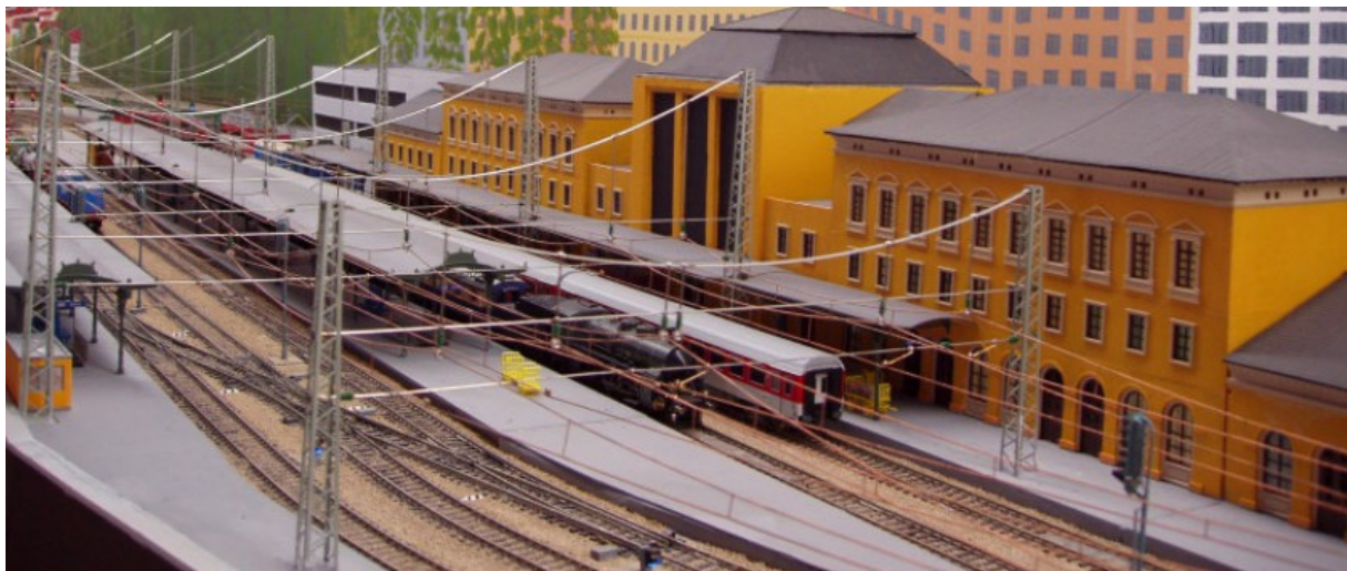
Obr. 4-1. Výjimka potvrzující pravidlo – fyzikální model brněnského hlavního nádraží slouží pro výuku dopravních zaměstnanců a umožňuje simulovat různé dopravní situace. Uspořádání kolejiště v modelu je oproti realitě odlišné. Foto poskytl firma Signal Projekt s.r.o.
