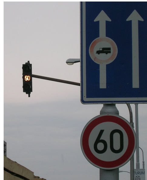
Obr. 6-7. Signální trychtýř – rychlostní signály, při jejichž dodržení řidič přijede k následující křižovatce v době zelené. Vpravo fotografie reálného rychlostního návěstidla (Hradec Králové, Rašínova třída, září 2010)
