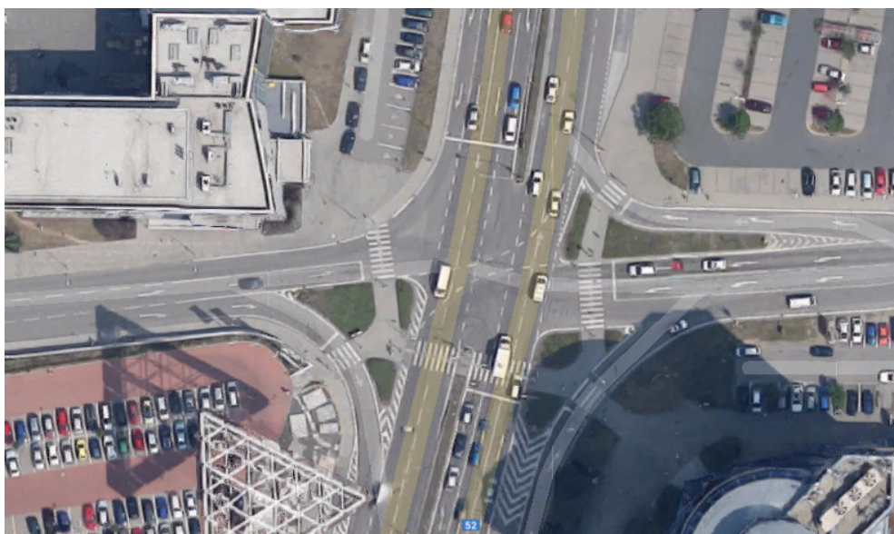
Obr. 6-25. Příklad křižovatky se zákazem jízdy přímo: Křižovatka ulic Heršpické (svisle, tzn. severojižně) a Bidláků (vodorovně) v Brně. Z ulice Bidláků je možné odbočit vpravo a vlevo, není však možné jet přímo, čímž odpadá jedná z fází signálního plánu.
