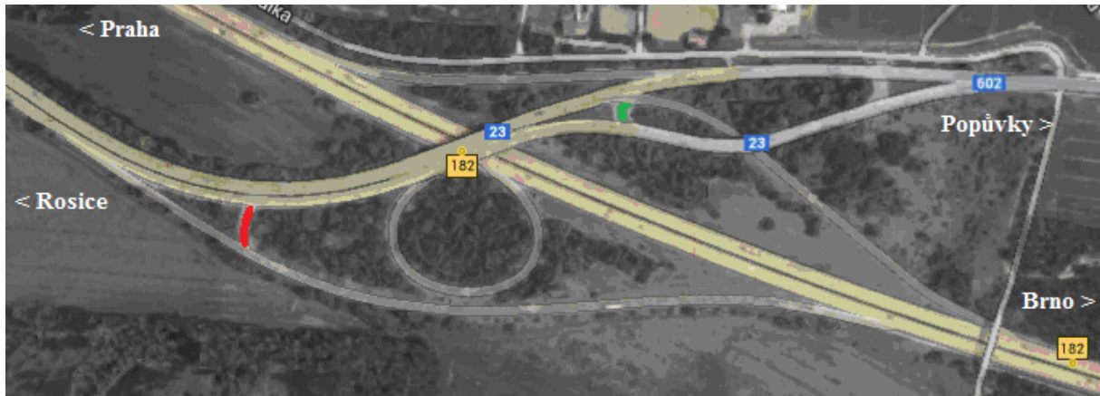
Obr. 6-26. Příklad mimoúrovňové křižovatky s omezením některých odbočení. Křižovatka dálnice D1 a silnice II/602 u Kývalky západně od Brna. Jízda od Popůvek na dálnici na Brno je možná jen s využitím vratné větve, která je ale kvůli svému provizornímu charakteru trvale uzavřená (červeně). Naopak vratná rampa pro jízdu z dálnice od Brna směr Popůvky je trvale otevřená (zeleně). Jízda od Prahy na Rosice a naopak je nemožná, což ovšem nevadí, protože je logičtější sjet z dálnice / na dálnici blíže od Prahy.
