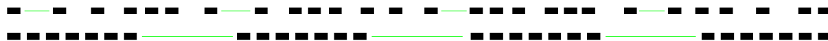
Obr. 6-5. V horní linii nepravidelné rozestupy dopravního proudu, kdy vozidla mívají větší rozestup než minimální (bezpečný), ale zároveň menší než potřebný pro vjezd vozidla z vedlejší (označen zeleně). Ve spodní linii dopravní proud usměrněný čekáním na návěst volno – zeleně vyznačena doba, kdy je možné jezdit z vedlejší.
