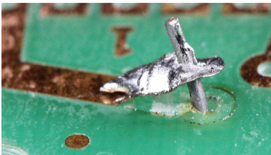
Obrázek 1.3 Delaminovaná pájecí ploška [12]
