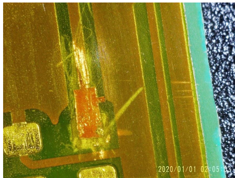
Obrázek 10.2 Nová pájecí ploška přelepená kaptonovou páskou
