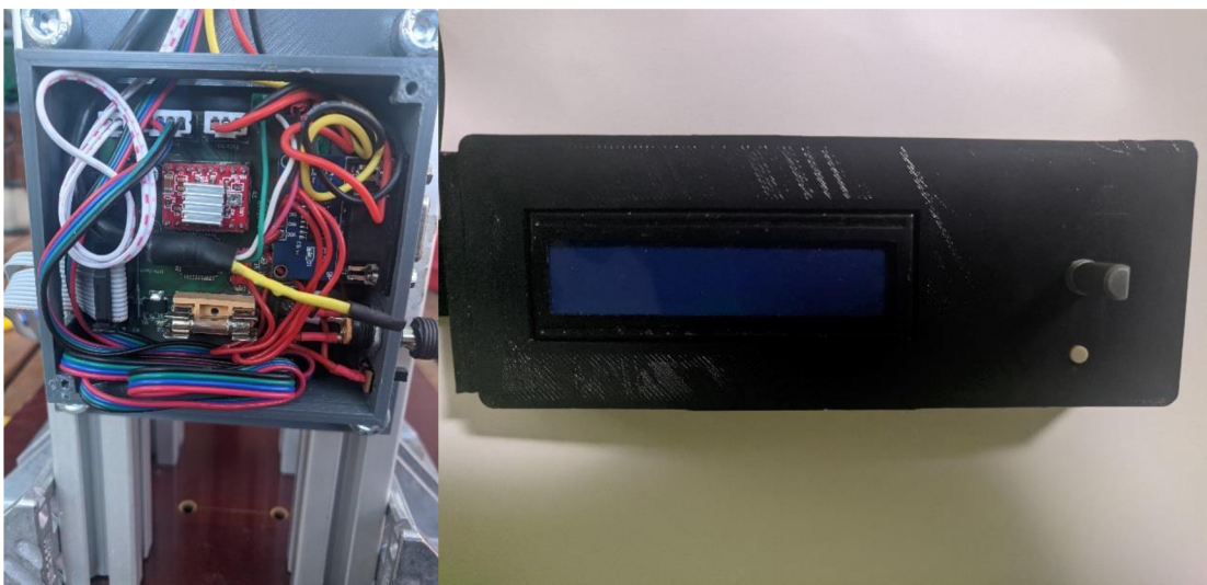
Obrázek 8.2 Řídící deska v krabičce (vlevo) a modul ovládání v krabičce (vpravo)
