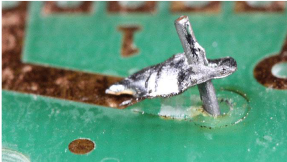
Obrázek 1.3 Delaminovaná pájecí ploška [12]
