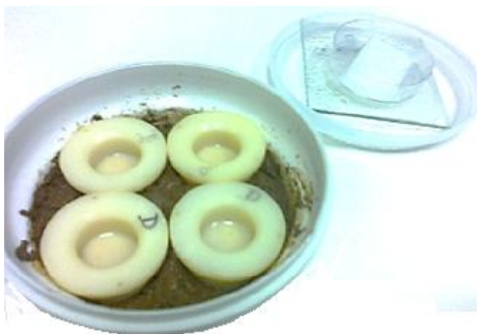
Obr. 14: DGT vzorkovací jednotky v půdě (foto vlastní)
