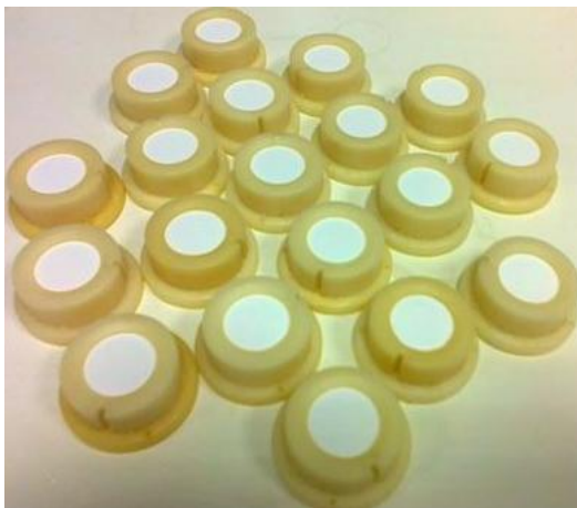
Obr. 15: Připravené DGT vzorkovací jednotky (foto vlastní)
