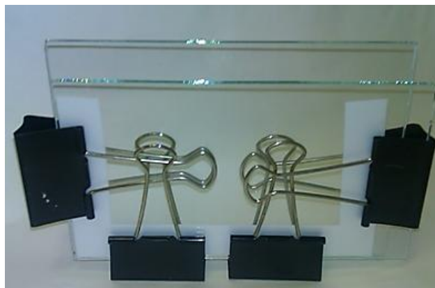
Obr. 13: Skleněné desky s distanční fólií pro výrobu gelů (foto vlastní)
