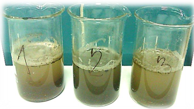
Obr. 11: Půdní suspenze pro měření pH (foto vlastní)
