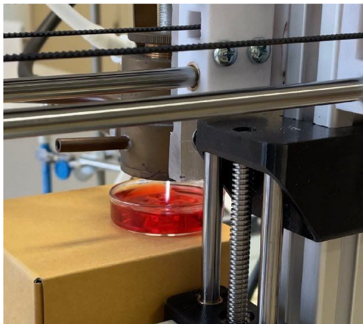
Obrázek 14: Působení proudu plazmatu mikrovlnného výboje na roztok barviva Saturnová červeň LAB
