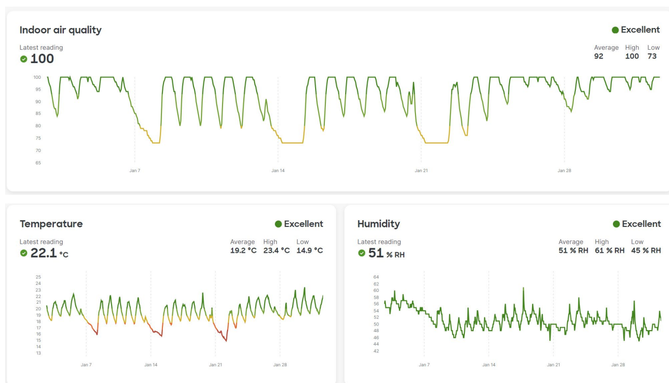
Obrázok 25: Senzor MT14 – Kuchynka - Kvalita, teplota a vlhkosť vzduchu (zdroj: vlastné spracovanie)
