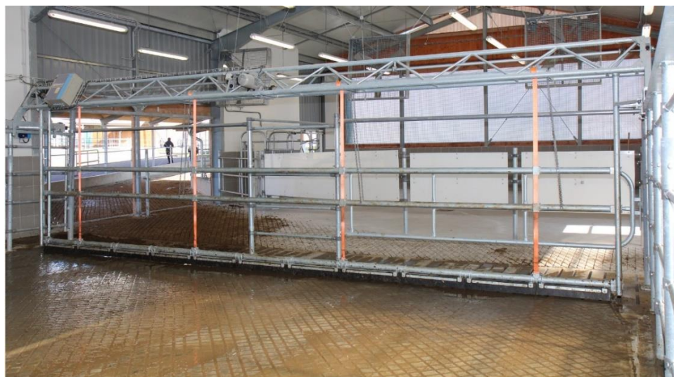
Obrázek 21 Mechanický posuvný přiháněč se shrnovačem kejdy
